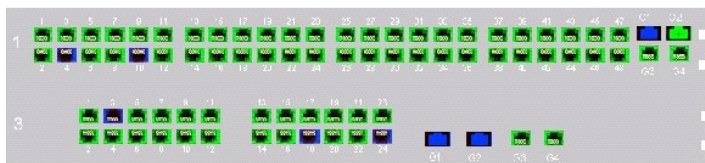
Figura 5-2. Indicadores de puerto del dispositivo PowerConnect
